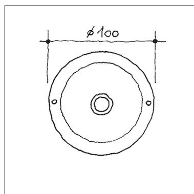
**Sonnerie rund, sichtbare Verschraubung, konkav zum Einlassen, Drucktaster aus Edelstahl**
