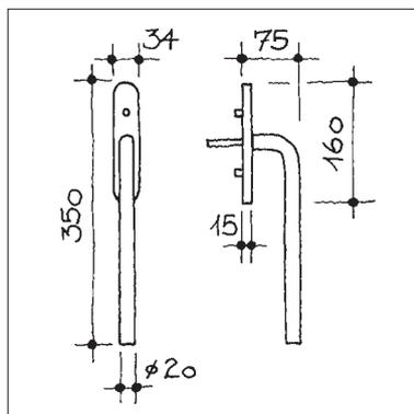
**Hebeschiebetürgriff, passend zu d line von Knud Holscher, auf massiver Grundplatte, Nockenverschaubung Distanz 80 mm, Stift 10x50 mm**
