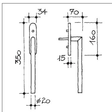
**Hebeschiebetürgriff auf massiver Grundplatte, Nockenverschraubung Distanz 80 mm, Stift 10x50 mm**
