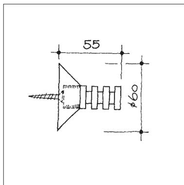
**Handtuch-/Kleiderhaken, unsichtbare Verschraubung mit Befestigungsmaterial**
