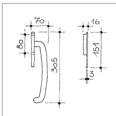
**Hebeschiebetürgriff-Set, mit Schiebetürmuschel aussen, Stift 10x90 mm, durchgehende Befestigungsschrauben M6x70 mm, Distanz 80 mm**
