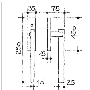
**Hebeschiebetürgriff, passend zur Linie SORATTE von John Pawson, auf massiver und gerundeter Grundplatte mit Kugelrasterung, Nockenverschraubung Distanz 80 mm, Stift 10x50 mm**
