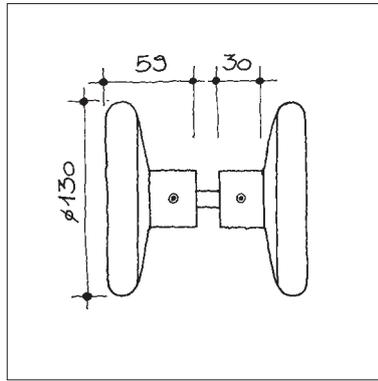
**Stos**griffpaar für Holztüren, d line von Knud Holscher, durchgehender Gewindebolzen M12, Türdicke bis 76 mm
