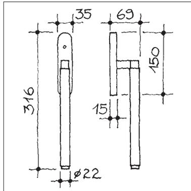
**Hebeschiebetürgriff, passend zur Linie SEMPIONE von Hans Kollhoff, Chassis Chrom glanz, Länge 250 mm, auf massiver Grundplatte mit Kugelrasterung, Nockenverschraubung Distanz 80 mm, Stift 10x50 mm**
