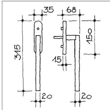
**Hebeschiebetürgriff** passend zur Linie **GOTTARDO** von Hans Kollhoff, Länge 250 mm, auf massiver Grundplatte mit Kugelrasterung, Nockenverschraubung Distanz 80 mm, Stift 10x50 mm
