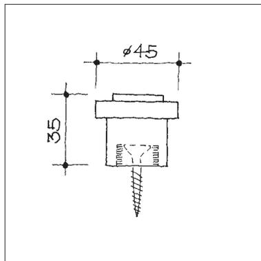
**Bodenpuffer mit Muffen-Verschraubung und Befestigungsmaterial**
