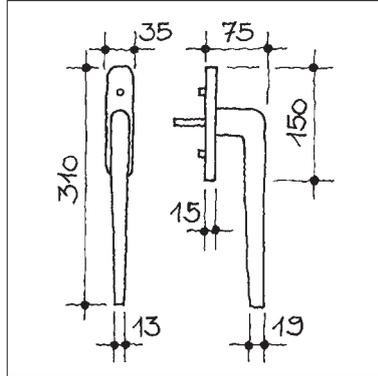
**Hebeschiebetürgriff, passend zur Linie LIVRIO von David Chipperfield, auf massiver Grundplatte mit Kugelrasterung, Nockenverschraubung Distanz 80 mm, Stift 10x50 mm**
