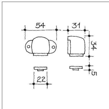
**Bodenpuffer mit gefederter Magnethaftung und Befestigungsmaterial**
