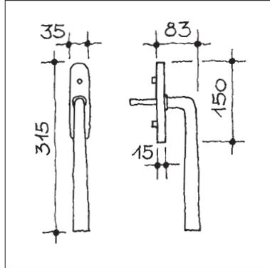
**Hebeschiebetürgriff, Grifflänge 250 mm, mit 90° Rasterung auf gerundeter Grundplatte, Verschraubung Distanz 80 mm, Stift 10x50 mm**
