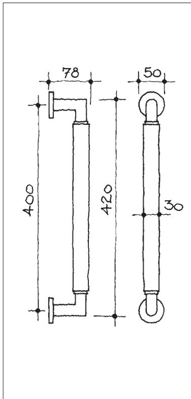
**S-Stossgriff ZYL, Chassis Ø 20 mm, unsichtbare Befestigung Distanz 38 mm**
