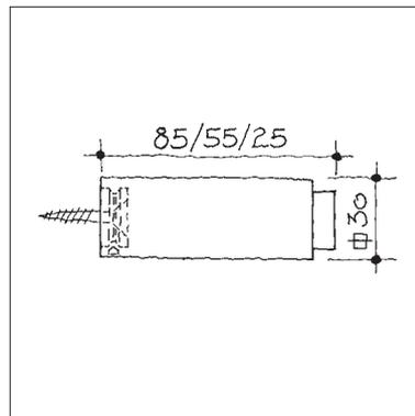
**Wandpuffer quadratisch mit Muffen-Verschraubung und Befestigungsmaterial**
