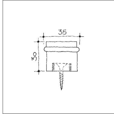
**Bodenpuffer mit Muffen-Verschraubung und Befestigungsmaterial**
