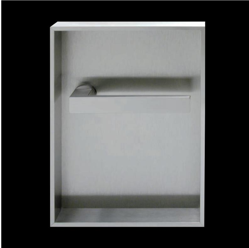
§-Einlassmuschel SEC, 226x156x21,5 mm, Seitenwandstärke 6 mm ohne Auflagerand, mit integriertem Drücker drehbar gelagert 120x18x5 mm, Stift 8 mm
