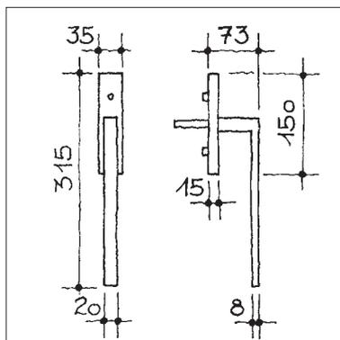
S-Hebeschiebetürgriff SEC, auf massiver rechteckiger Grundplatte mit Kugelrauerung, Nockenverschraubung Distanz 80 mm, Stift 10x50 mm
