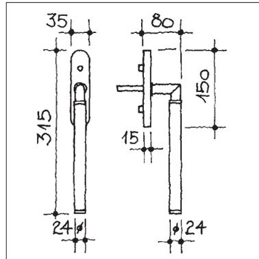
§-Hebeschiebetürgriff LEA, individuelle Konfektionierung von Chassis in Messing, Chrom, Edelstahl etc., kombiniert mit Leder in diversen Farben, massive und gerundete Grundplatte mit Kugelrasterung, Nockenverschraubung Distanz 80 mm, Stift 10x50 mm
