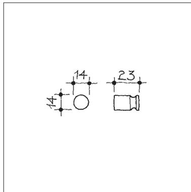
**Haken mit Kerbe d line von Knud Holscher, mit unsichtbarer Befestigungsmuffe**
