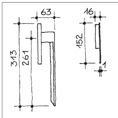
**Hebeschiebetürgriff-Set, BRENNO von Yoshimi Kono, mit Schiebetürmuschel aussen, Stift 10x50 mm, durchgehende Befestigungsschrauben M6x70 mm, Distanz 80 mm**
