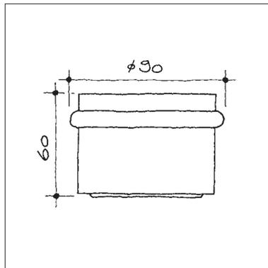
**Bodenpuffer, Verwendung ohne Befestigung, zum Verschieben, 2,45 kg**
