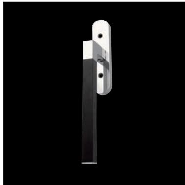
**S-Hebeschiebetürgriff ANA, Metallteile Edelstahl, Handhabe aus schwarzem Ebenholz, massive Grundplatte mit Kugelrasterung, Nockenverschraubung Distanz 80 mm, Stift 10x50 mm**
