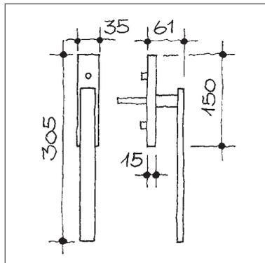
**Hebeschiebetürgriff, CHICAGO, auf massiver Grundplatte mit Kuglrasterung, Nockenverschaubung Distanz 80 mm, Stift 10x50 mm**
