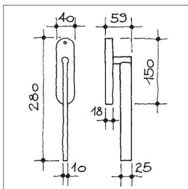
**Hebeschiebetürgriff passend zur Linie Wilhelm Wagenfeld, Grifflänge 230 mm, mit 90° Rasterung auf gerundeter Grundplatte, Verschraubung Distanz 80 mm, Stift 10x60 mm**
