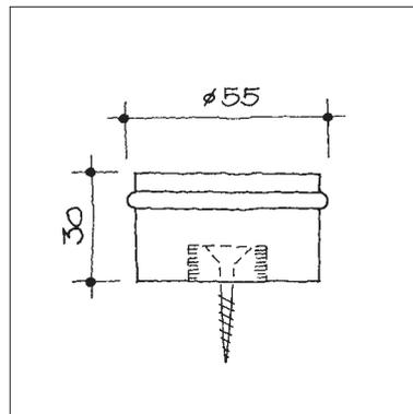
**Bodenpuffer mit Muffen-Verschraubung und Befestigungsmaterial**
