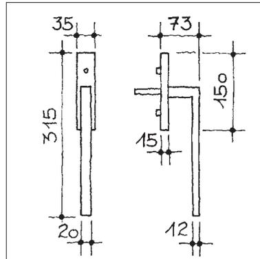
↳ **Hebeschiebetürgriff ULA, massive Grundplatte mit Kugelrasterung, Nockenverschraubung, Distanz 80 mm, Stift 10x50 mm**
