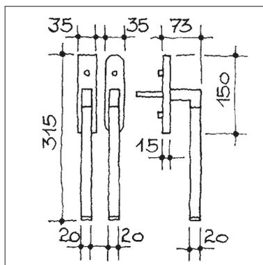
**S-Hebeschiebetürgriff ANA, Metallteile Edelstahl, Handhabe aus Holz nach Wahl, massive Grundplatte mit Kugelrasterung, Nockenverschraubung Distanz 80 mm, Stift 10x50 mm**
