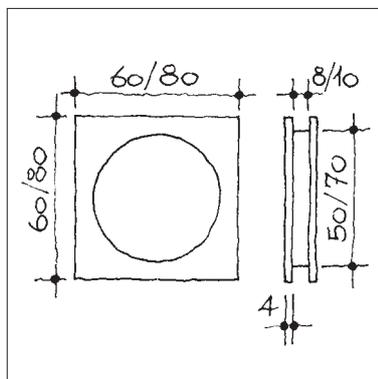
**Schiebetürmuschel-Paar zum Verschrauben mit Glasschutz, für Glasstärke 8-10 mm**
