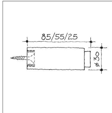
**Wandpuffer mit Muffen-Verschraubung und Befestigungsmaterial**
