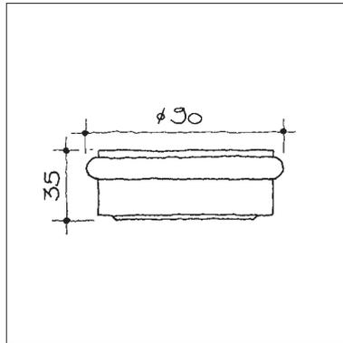
**Bodenpuffer, Verwendung ohne Befestigung, zum Verschieben, 1,2 kg**
