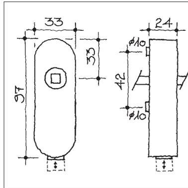
**Abschliessbare Fenster-Rasterrosette, leicht konisch, mit Druckzylinder, gleichschliessend mit 2 Schlüssel, Stift Fensterseite 7x35 mm, Griffseite 8 mm**
