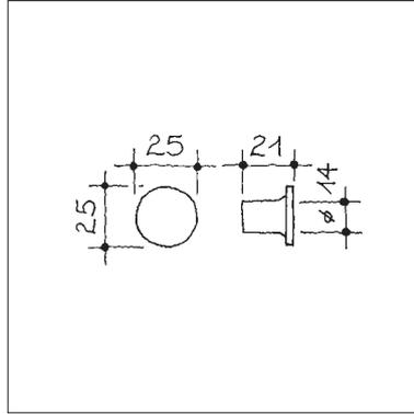
**Haken mit Kopfplatte d line von Knud Holscher, mit unsichtbarer Befestigungsmuffe**
