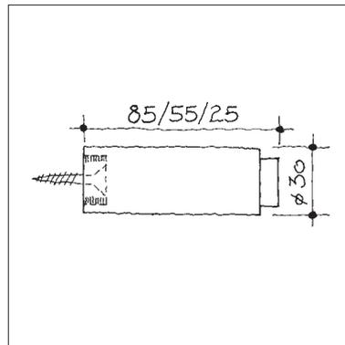
**Wandpuffer mit Muffen-Verschraubung und Befestigungsmaterial**
