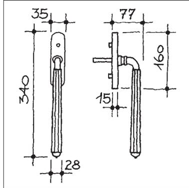
**Hebeschiebetürgriff passend zur Serie HELENA, Messing Sandguss, auf massiver Grundplatte, Nockenverschraubung Distanz 80 mm, Stift 10x50 mm**
