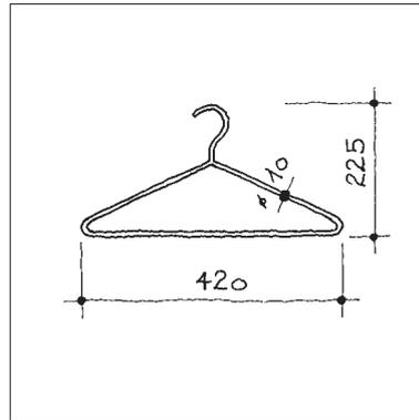
**Kleiderbügel, Haken drehbar, unten geschlossen für Hosen**
