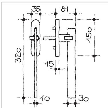
**Hebeschiebetürgriff, passend zur Linie SUBASIO von Richard Meier, auf massiver Grundplatte mit Kuglrasterung, Nockenverschraubung Distanz 80 mm, Stift 10x50 mm**
