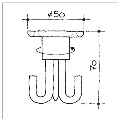
**Decken-Garderobenhaken, 3-fach, drehbar, sichtbar verschraubt**
