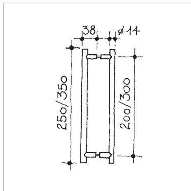
**Stossgriffpaar für Glastüren, durchgehende Verschraubung M5 und Kunststoffscheiben, Sockel  $\varnothing 12$  mm**
