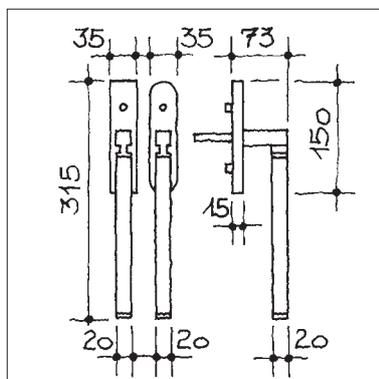
§-Hebeschiebetürgriff ART, individuelle Konfektionierung von Chassis und Handhabe, massive Grundplatte mit Kugelrasterung, Nockenverschraubung Distanz 80 mm, Stift 10x50 mm
