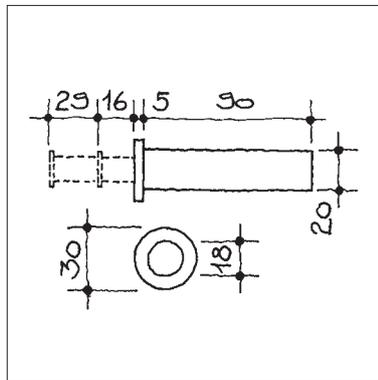
**Kleiderhaken mit ausziehbarer Verlängerung (16/45 mm), die sich durch leichtes Drücken selbständig öffnet (Feder-Magnet-Mechanismus), zum Einbohren in Kastenwange, Durchmesser 20x90mm**
