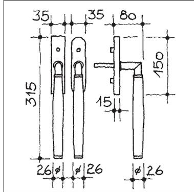
§-Hebeschiebetürgriff ONO, Metallteile Nickel silberglanz poliert, Handhabe aus schwarzem Ebenholz, massive Grundplatte mit Kugelrasterung, Nockenverschraubung Distanz 80 mm, Stift 10x50 mm
