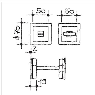
**S-Verschluss-Set für WC-Schiebetüren, 2 quadratische Einlassmuscheln mit integriertem Drehriegel innen und Notöffnung aussen, minimale Türdicke 50 mm**
