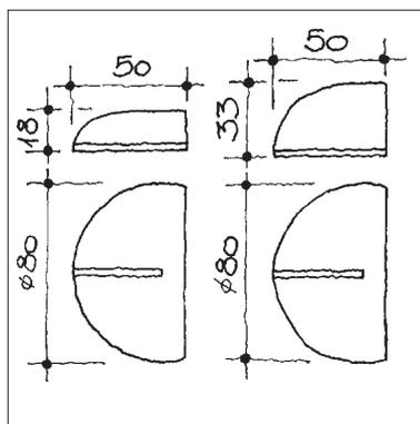
**Bodenpuffer d line von Knud Holscher, mit Befestigungsmaterial, Höhe 18 mm**
