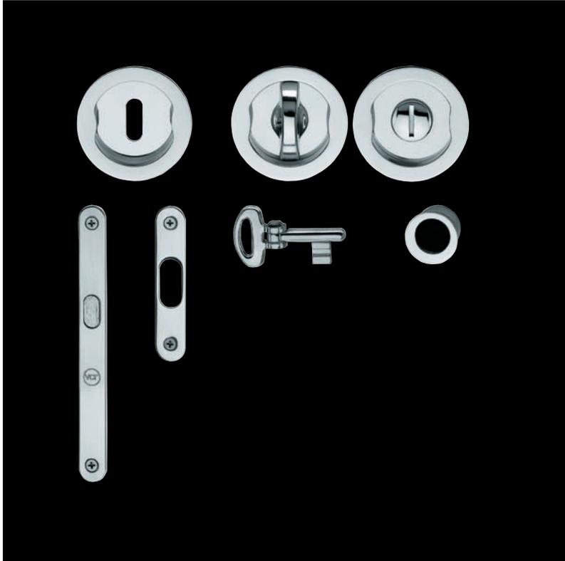
**Verschluss-Set für Zimmer- oder WC-Schiebetüren, Einsteckschloss mit Zirkelriegel und Schliessblech, 2 runde Einlassmuscheln mit integriertem Drehgriff innen und Notöffnung aussen oder Klappschlüssel, 1 stirnseitige Einbohr-Zugmuschel**
