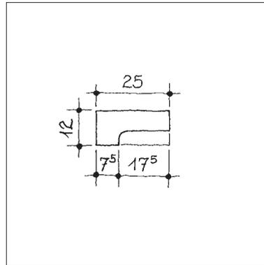
**Möbel-Griffleiste mit Ausfräsung, von Martin Siebenmann, Gewinde M4**
