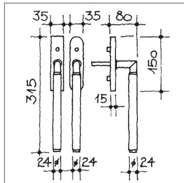
§-Hebeschiebetürgriff ZYL, massive Grundplatte mit Kugelrasterung, Nockenverschraubung Distanz 80 mm, Stift 10x50 mm
