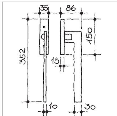
**Hebeschiebetürgriff passend zur Linie Schmidt, Hammer und Lassen, Grifflänge 300 mm, mit 90° Rasterung auf eckiger Grundplatte, Verschraubung Distanz 80 mm, Stift 10x60 mm**
