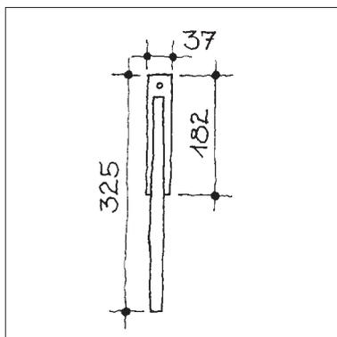
**Hebeschiebetürgriff ART BRUT, eckige Grundplatte mit 180° Rasterung, Nockenverschraubung, Distanz 80 mm, Stift 10x50 mm**
