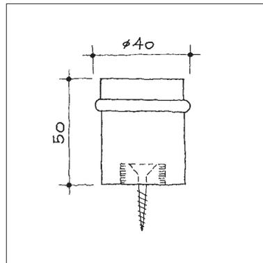
**Bodenpuffer mit Muffen-Verschraubung und Befestigungsmaterial**
