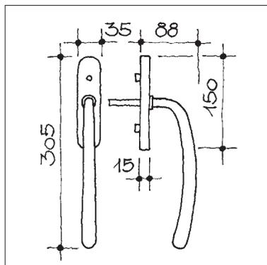
**Hebeschiebetürgriff FLUXUS von R. Matthias Leuppi, auf massiver Grundplatte mit Kuglrasterung, Nockenverschraubung Distanz 80 mm, Stift 10x50 mm**
