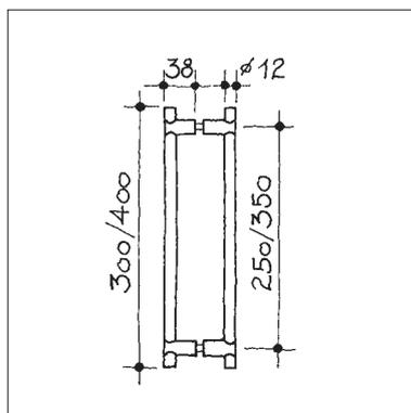
**Stossgriffpaar für Glastüren, durchgehender Bolzen  $\varnothing 6$  mm, Befestigung mit Inbusschraube, Sockel  $\varnothing 18$  mm**
