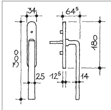
**Hebeschiebetürgriff passend zu OLVA, Grifflänge 220 mm, mit 90° Rasterung auf gerundeter Grundplatte, Verschraubung Distanz 80 mm, Stift 10x60 mm**
