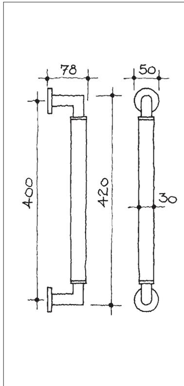
**Stossgriff LEA, individuelle Konfektionierung von Chassis in Messing, Chrom, Edelstahl etc., kombiniert mit Leder in diversen Farben, Chassis Ø 20 mm, unsichtbare Befestigung Distanz 38 mm**
