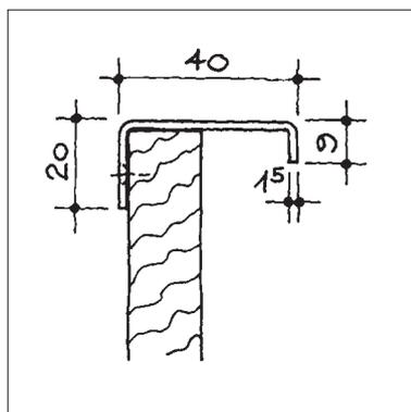
**Möbel-Griffleiste, gekantete Griffleiste zur rückseitigen Befestigung**
