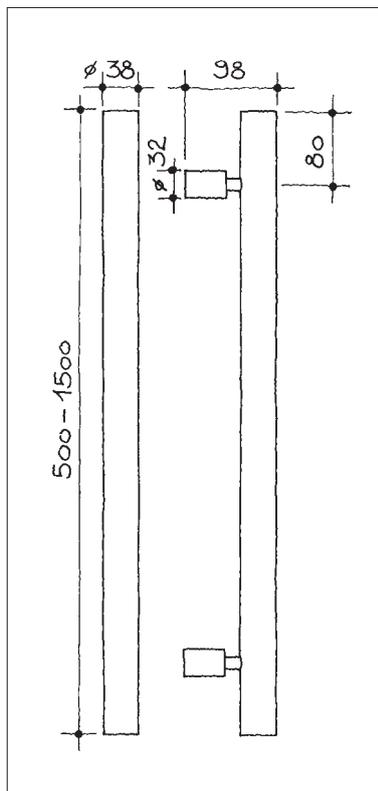
**Stossgriff d line von Knud Holscher, Edelstahl matt geschliffen, Gewindeaufnahme M12 oder Muffenöffnung, ohne Montagematerial**
